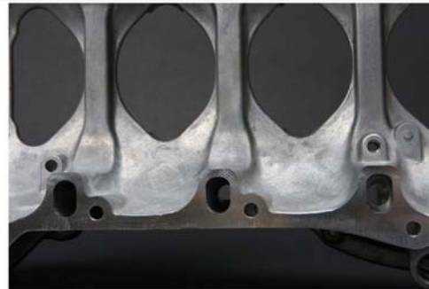
●オイルパン側/オイルライン
